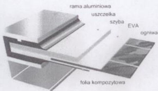
Rysunek 5 Budowa panelu w przekroju
